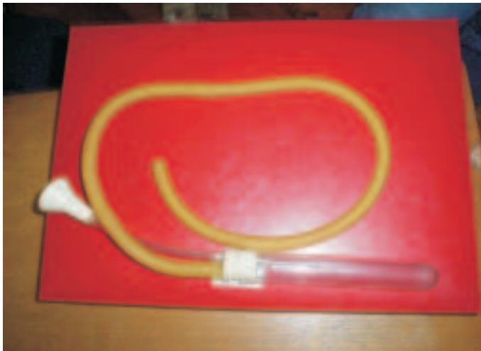
FIGURA 12 - CAPTURADORES A BASE DE SUÇÃO
