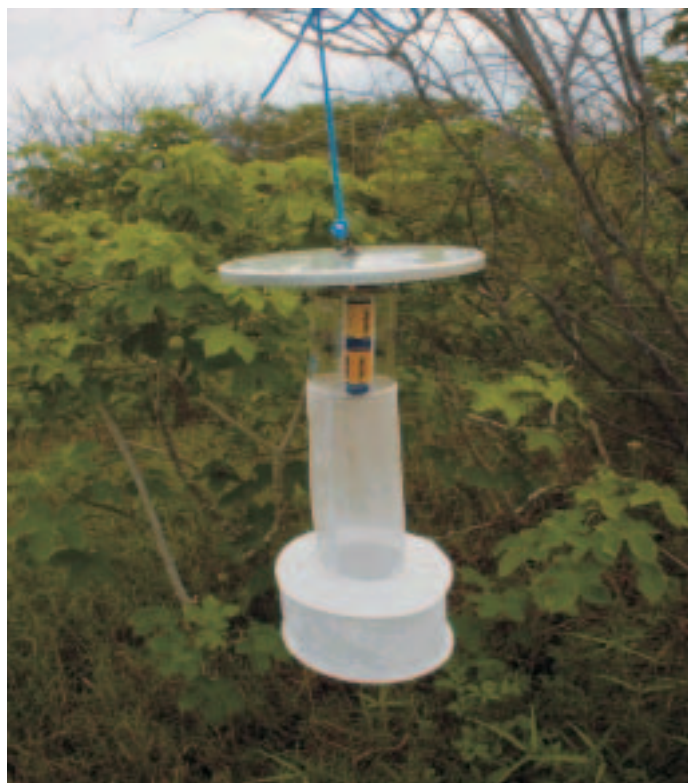
FIGURA 29 - ARMADILHA PARA CAPTURA DE MOSQUITO TIPO CDC
